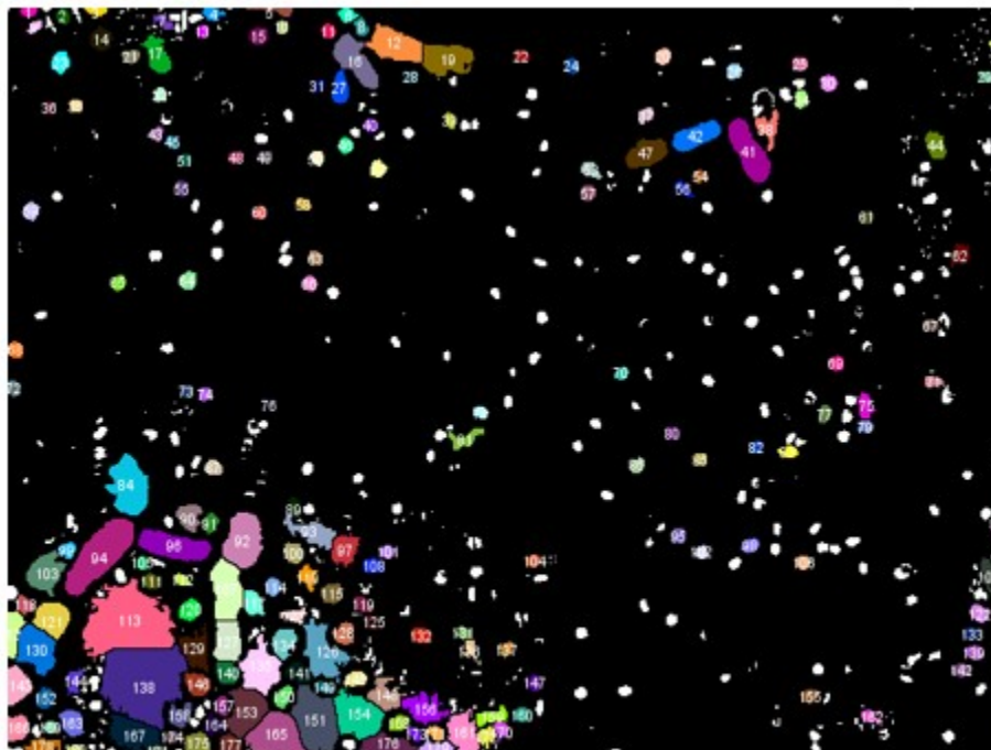
Fig. 6. Procesamiento realizado mediante el software ImageJ para el conteo de bacterias y levaduras.
